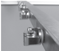
Tube pulvérisateur avec buses à jet plan montées
