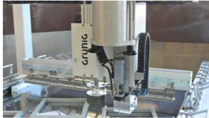
Multifunktionaler Klebkopf: messen, kleben und aushärten
