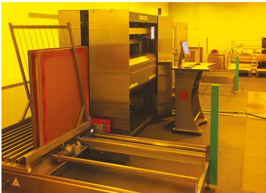
Decordecals 的 SignTronic STM Tex Pro 10 内联单元。若要获得完美的屏幕，SignTronic 建议使用黄色光线（无紫外线光线条件）
