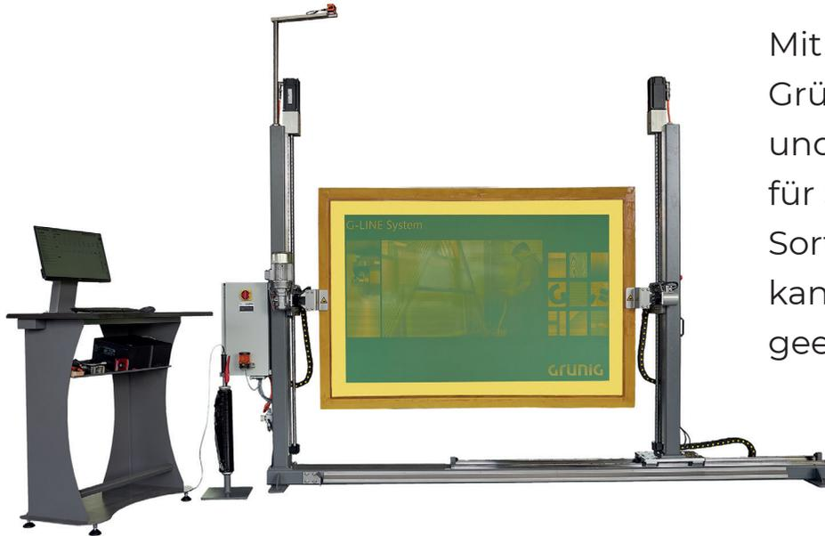
Mit dem G-Proof 390 hat Grünig eine neue Inspektions- und Verpackungsmaschine für Siebdruckschablonen im Sortiment – was diese leisten kann und für wen die Einheit geeignet ist.
